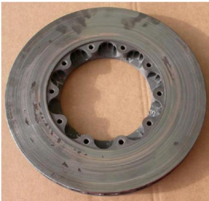
Disco en buen estado después de 6.000 Km de circuito
