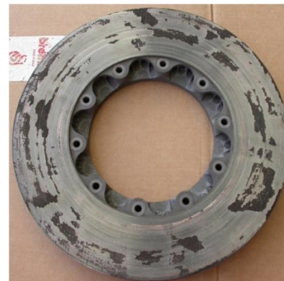
Disco en mal estado. Fin de su vida útil.
